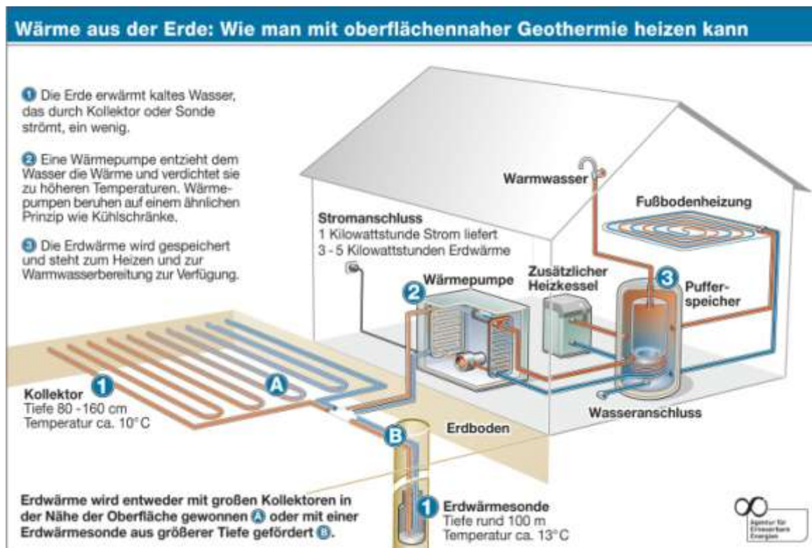
Abbildung 45 - Funktionsprinzip Erdwärmesonde mit Wärmepumpe
